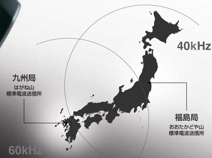
あらためて電波時計について触れてみたい。電波時計とは、情報通信研究機構が運用している時刻情報をのせた電波（標準電波）を受信し、その時刻情報をもとに正確な時刻を表示する時計だ。標準電波の時刻情報は、およそ10万年に誤差1秒という超高精度を保つ「セシウム原子時計」によるもので、日本国内では福島局(40kHz)と九州局(60kHz)の2ヶ所の標準電波送信所からそれぞれ異なる周波数で送信されている。ブライトの電波時計はすべて、この2つの周波数を自動的に選択して受信することができるため、大変便利だ。
